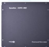
Локальный блок связи – специализированное серверное оборудование, связующее звено системы. Обеспечивает коммутационную связью и питанием 36 В все остальные компоненты.
