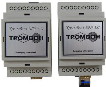
Конвертеры оптические «Тромбон SFP-LC» используются в составе систем промышленной автоматики и телеметрии для двусторонней передачи сигналов четырехпроводного интерфейса RS485 (RS422) по одному оптическому одномодовому волокну.
