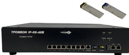
Коммутатор PoE промышленный управляемый L2. Исполнение 19" (2U) стоечно-настенное. Оснащен встроенным блоком питания на 230В и возможностью установки резервных АКБ для поддержания работы коммутатора и подключенных по PoE устройств в отсутствие основного напряжения. В комплект входят два SFP-модуля. Сертифицирован согласно требованиям пожарной безопасности ТР ЕАЭС-043/2017.
