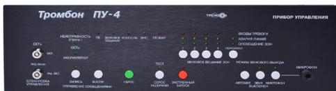
Прибор управления на 4 зоны для построения систем оповещения 3-го и 4-го типов. Создан на современной элементной базе, имеет гибкие настройки алгоритмов оповещения, интеллектуальную систему контроля всех линий связи, порт для подключения удаленных консолей и интерфейс для подключения ПК.
