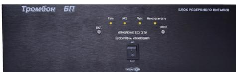
Блок резервного питания «Тромбон БП-21» обеспечивает бесперебойным низковольтным питанием (24-30 В) усилители мощности, входящие в состав системы оповещения и управления эвакуацией. Блок питания также используется для питания системы эвакуационного освещения и управления дополнительными техническими средствами: световыми указателями направления движения, замками дверей эвакуационных выходов, звуковыми излучателями, генераторами сирены и т.д.
