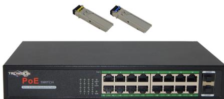
Промышленные PoE коммутаторы для коммутации IP - устройств по проводной сети. Оснащены встроенным блоком питания. В комплект входят два SFP-модуля. Исполнение в металлическом корпусе классом защиты IP20 с возможностью крепления на стену и монтажа в 19” стойку.
