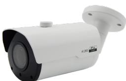
Уличная 2Мп IP-камера. Оснащена моторизированной оптикой 2.8-12 мм с углом обзора 114 ~ 33° и ИК-подсветкой до 40 метров. Поддержка кодеков H.265/H.264. Имеет разъем для подключения микрофона и слот для SD-карты. В камере реализована поддержка ONVIF и Cloud технологий, включая мобильный доступ, что позволяет производить удаленный просмотр видео потока и архива. Металлический корпус IP66. Питание 12В и PoE.
