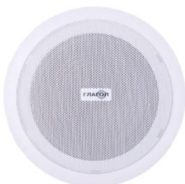
Потолочные оповещатели «Глагол» серии П предназначены для систем речевого оповещения и звуковой трансляции. Неравномерность АЧХ в диапазоне от 100 до 10000 Гц составляет не более 5 дБ. Небольшие по высоте габариты позволяют устанавливать их на подвесные фальш – панели с небольшим подпотолочным пространством. Корпус оповещателей выполнен из высококачественного пластика.
