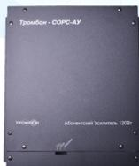
Абонентский усилитель «Тромбон СОРС-АУ» предназначен для организации громкоговорящей связи на базе системы «Тромбон СОРС». Усилитель располагается в зонах оповещения, подключается на линии связи с ЛБС аналогично АВУ. К усилителю возможно подключение громкоговорителей с входным напряжением 30 или 100 В и суммарной мощностью до 120 Вт.
