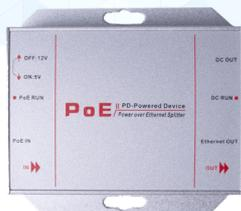
Сплиттер используется для разделения питающего напряжения и данных, передаваемых по Ethernet 10/100 Мбит/с. Разделение PoE линии на линию Ethernet и линию DC 5/12 В. PoE вход до 25,5 Вт (IEEE802.3at). Выходы - DC 5/12 В, с потреблением от 12 до 24 Вт и выход Ethernet. Питание от PoE линии. Металлический кожух, возможность крепления на стену.
