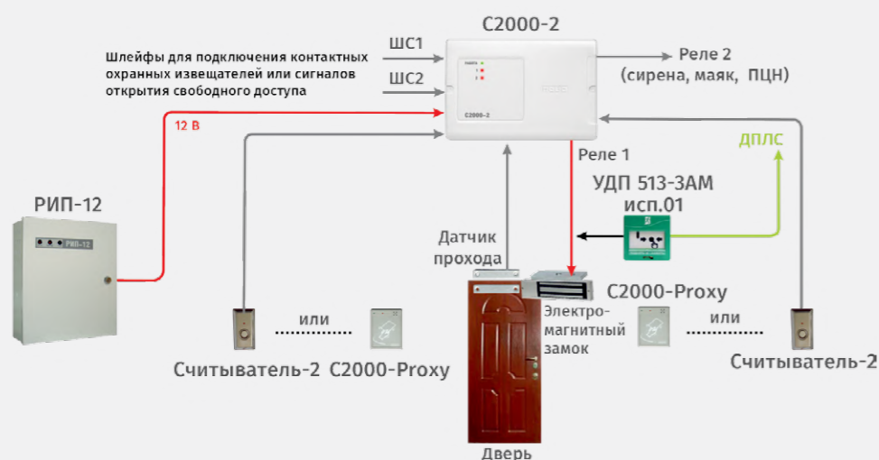
Рисунок 53. Режим работы «Одна дверь на вход/выход»
