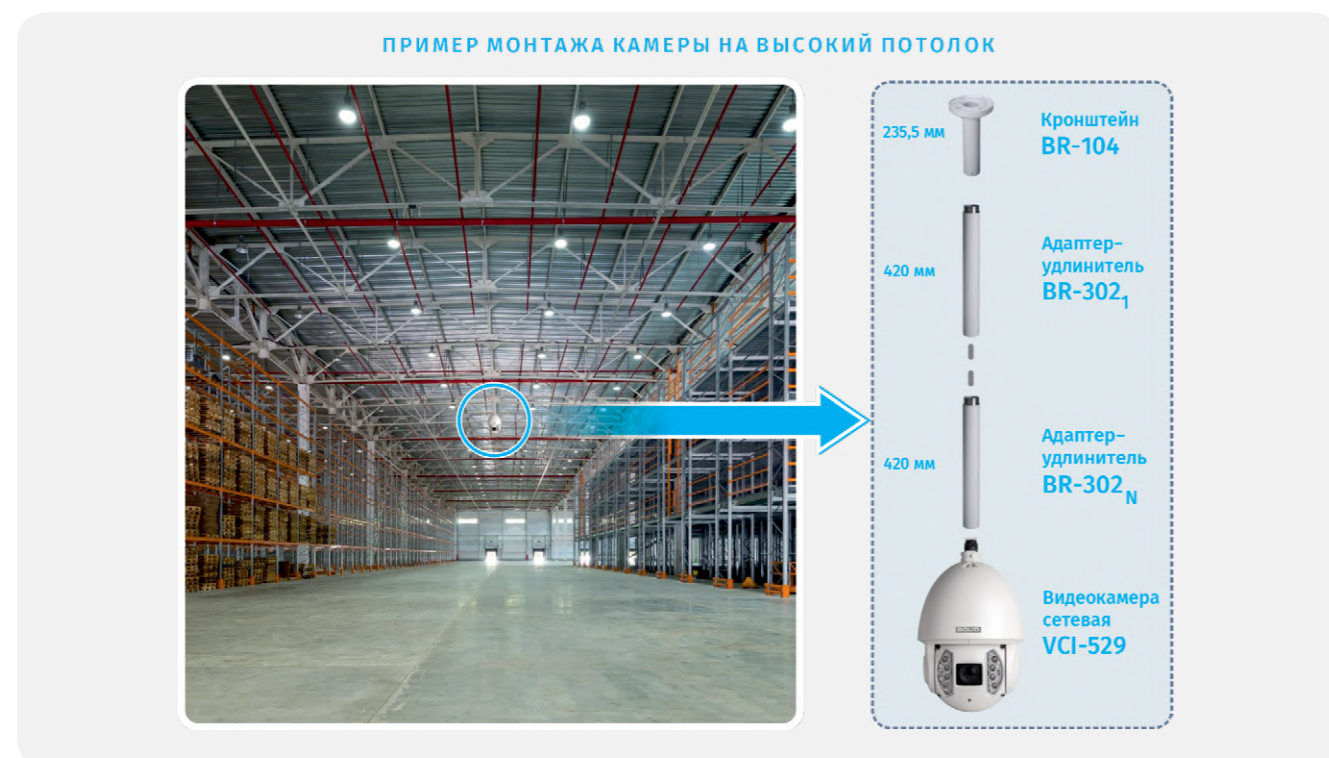
Рисунок 78. Пример монтажа поворотной камеры с помощью адаптеров-удлинителей
