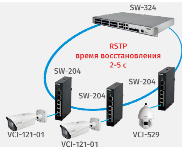
Рисунок 75. Примеры кольцевых топологий для построения периметральных систем видеонаблюдения
