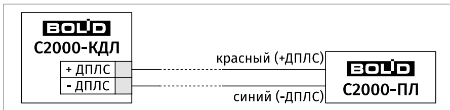
Рисунок 16. Типовая схема включения извещателя с кабелем №1 в ДПЛС КДЛ.
