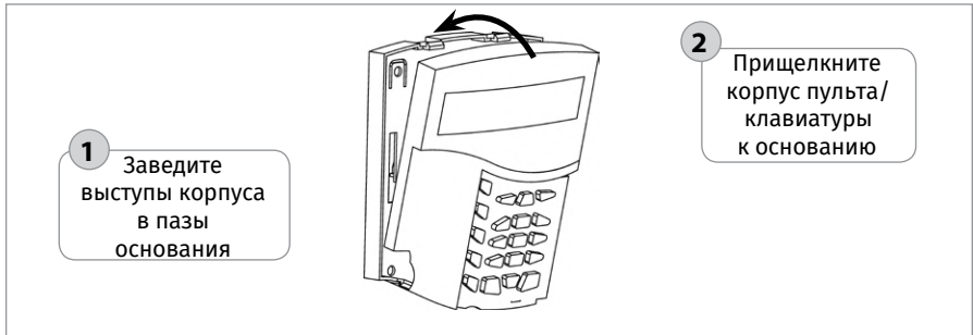
Рисунок 7. Установка корпуса пульта «С2000М», «С2000М исп.02»
