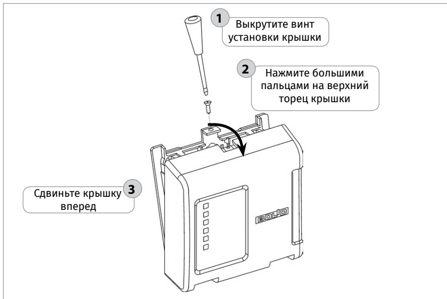
Рисунок 25. Снятие крышки прибора
