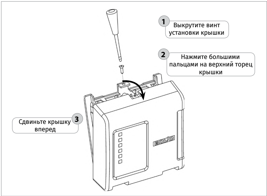
Рисунок 35. Снятие крышки изделия
