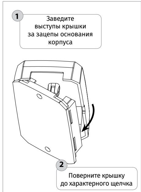
Рисунок 23. Установка крышки прибора
