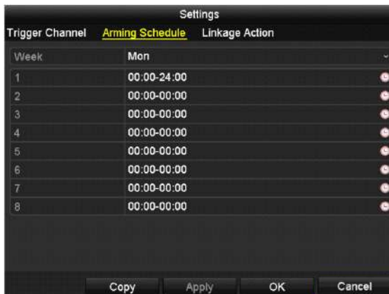
Рисунок 8-4 Установка расписания постановки на охрану обнаружения движения
