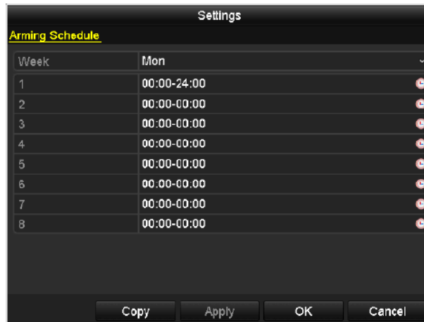
Рисунок 8-20 Установка расписания постановки на охрану тревожного выхода
