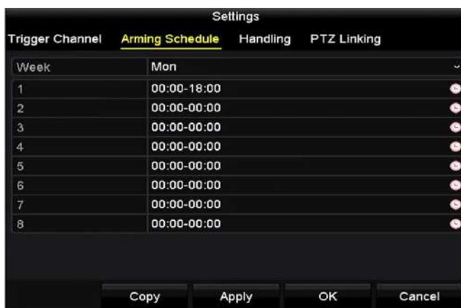
Рисунок 9-17 Установка расписания постановки на охрану
