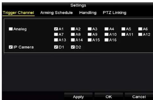
Рисунок 9-16 Установка срабатывающих каналов POS
