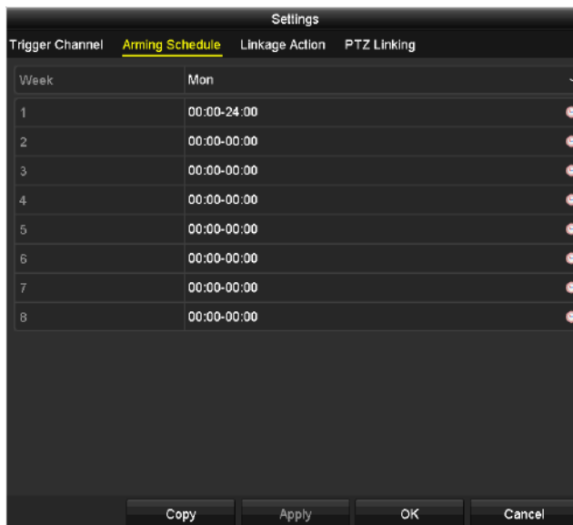
Рисунок 8-7 Установка расписания постановки на охрану тревожного входа
