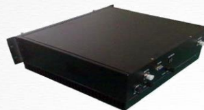
5W полосовой распределенный, прямое подключение (Донорный модуль)
