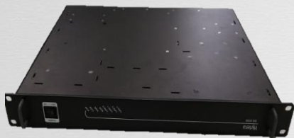
5W 16 канальный. Прямое / беспроводное подключение к БС (Донорный модуль).
