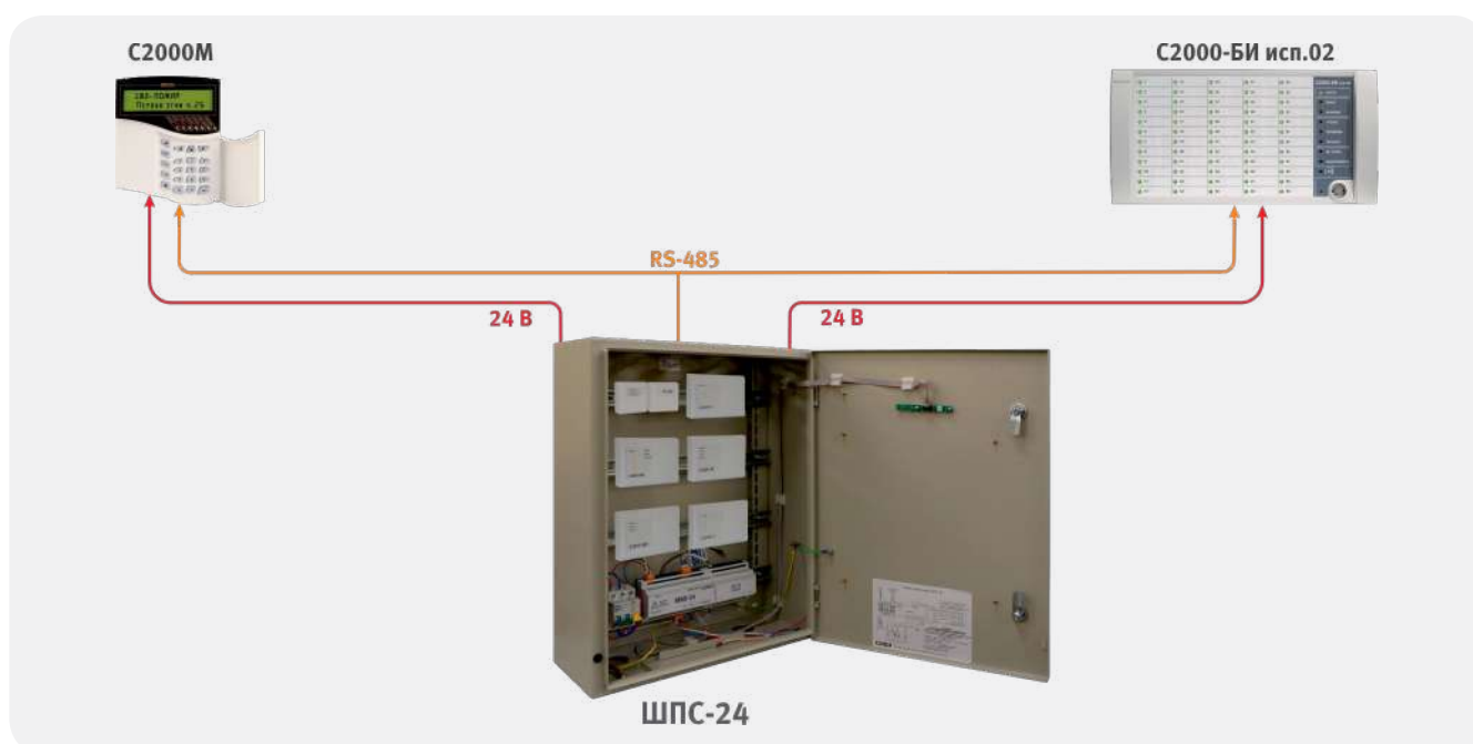
Рисунок 13. Шкаф пожарной сигнализации со встроенным РИП
