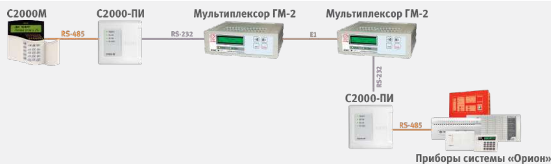
Рисунок 94. Структурная схема использования мультиплексора «ГМ-2» с пультом «С2000М»
