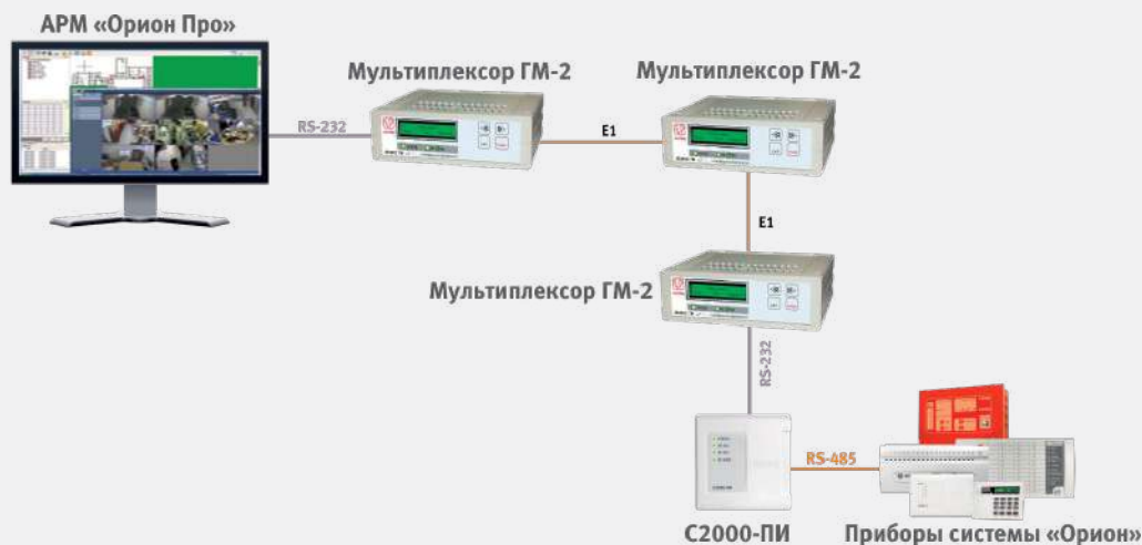
Рисунок 93. Структурная схема использования мультиплексора «ГМ-2» с АРМ «Орион»/«Орион Про» с подключением промежуточного мультиплексора (ремultipлексирование)
