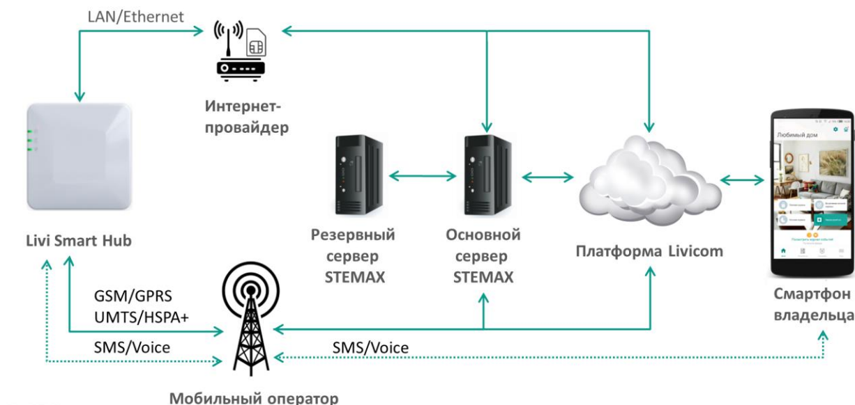
Рис. 3.10. Структура решения по интеграции системы Livicom с ПО STEMAX при использовании технологии резервирования серверов
